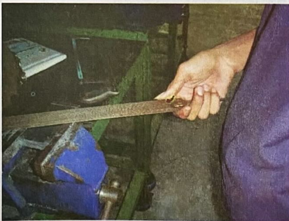
รูปที่ 1.12 ใช้ตะไบไม่มีด้าม อาจทิ่มแทงมือได้
