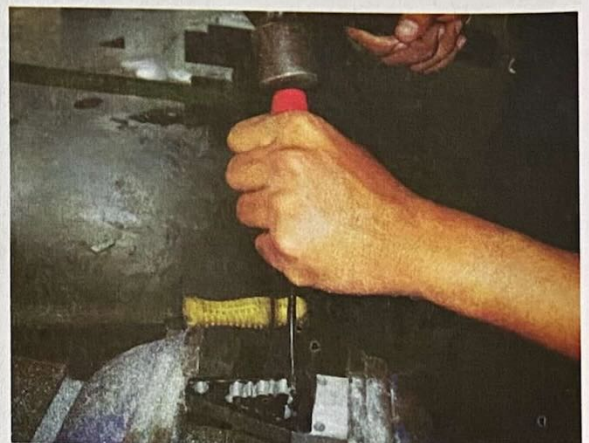
รูปที่ 1.13 ใช้ไขควงแทนสากัด เป็นการใช้เครื่องมือผิดประเภท ไขควงอาจหักทิ่มมือได้
