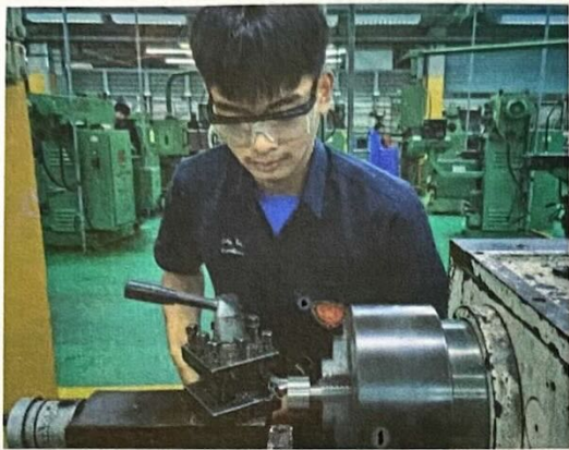
รูปที่ 1.14 การแต่งกายถูกต้องรัดกุม สวมแว่นตานิรภัย ขณะปฏิบัติงานกลึง
