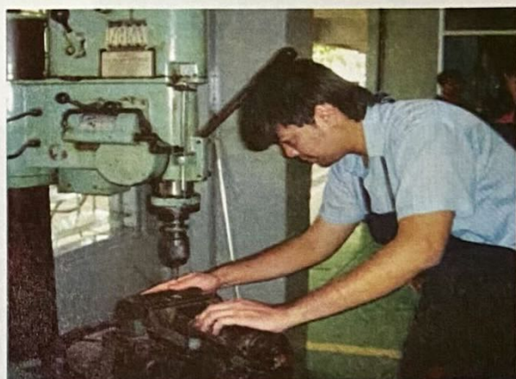
รูปที่ 1.7 ผู้ปฏิบัติงานประมาท เลินเล่อ ขาดความระมัดระวัง แขนหมุนกระแทกศีรษะ
