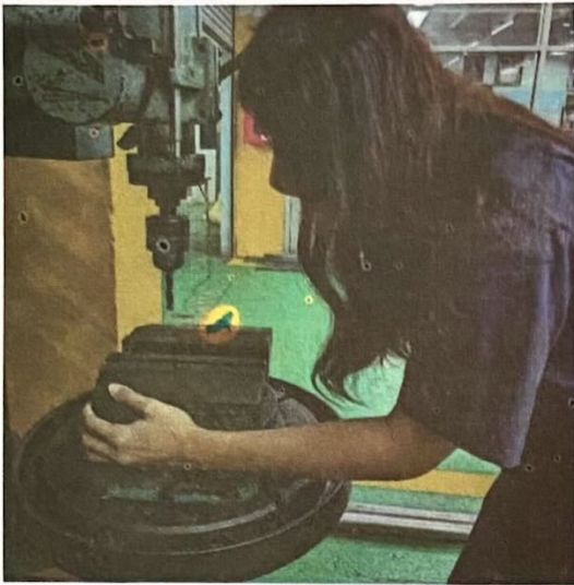
รูปที่ 1.8 ผู้ปฏิบัติงานไว้ผมยาวอาจเกิดอันตรายได้
